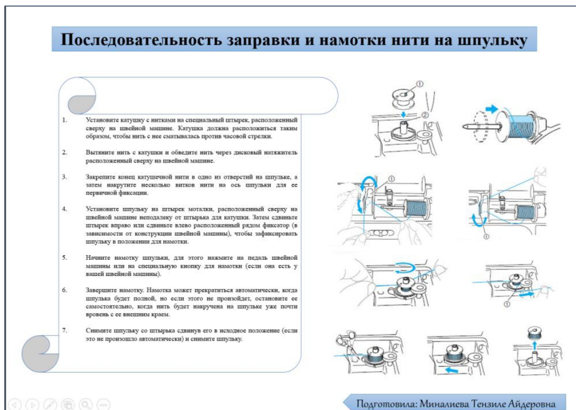
Рис. 3. Последовательность заправки и намотки нити на шпульку
