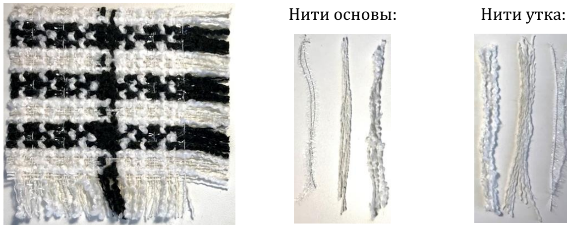
Рис. 2. Фото образца неоднородной ткани и ее нитей основы и утка
